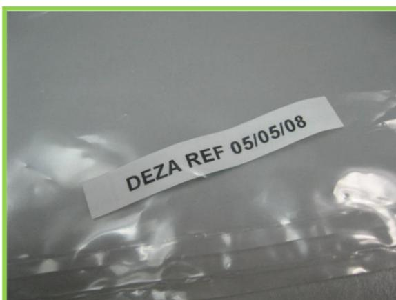
En caso de usar bolsas, una de las etiquetas se colocará dentro de la bolsa en la que se ha depositado el material recogido, y la otra en la bolsa exterior. En la medida de lo posible, se recomienda el uso de etiquetas impresas en tiras de plástico, ya que tienen una mayor resistencia. También se aconseja rotular los recipientes con rotuladores indelebles resistentes al alcohol.
